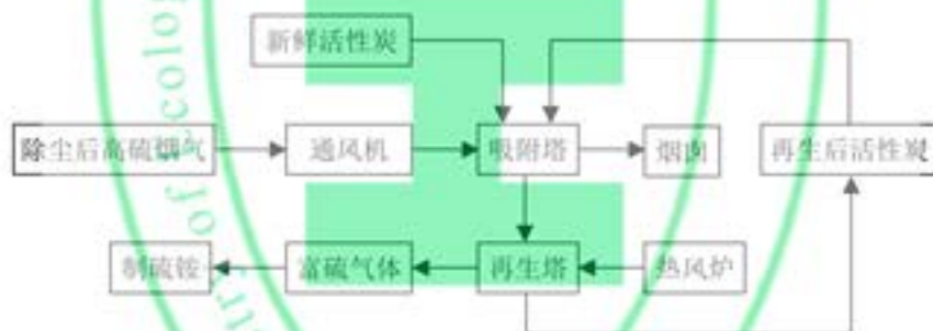
图 5 活性炭（焦）法脱硫工艺流程
