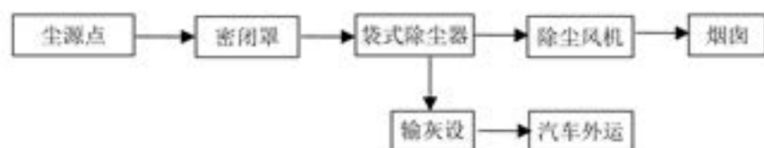
图 18 焦处理除尘工艺流程
